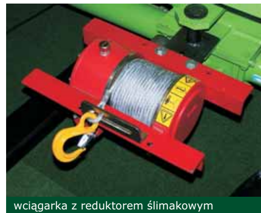
wciągarka 10-tonowa z okienkiem rolkowym
