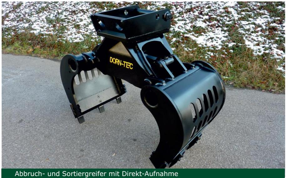
Abbruch- und Sortiergreifer mit Direkt-Aufnahme
