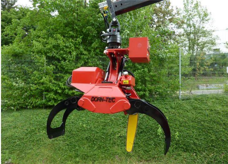
Hochleistungs-Rundholzgreifer mit Kettensäge und Tiltfunktion
