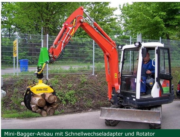
Mini-Bagger-Anbau mit Schnellwechseladapter und Rotator
