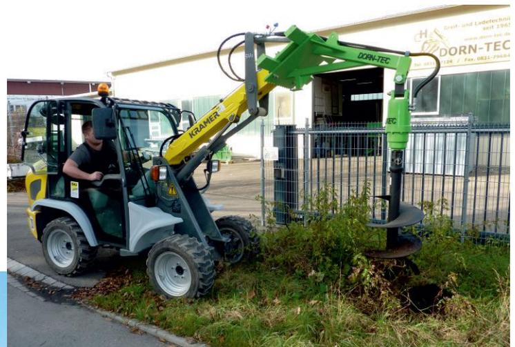
Bohrgerät mit Adapter für einen Radlader made by DORN-TEC
