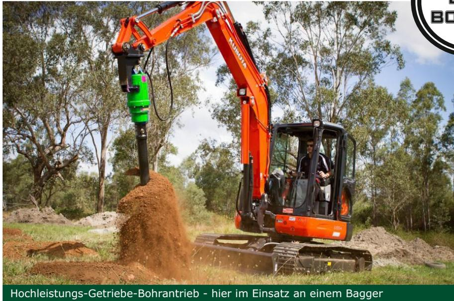
Hochleistungs-Getriebe-Bohrantrieb - hier im Einsatz an einem Bagger
