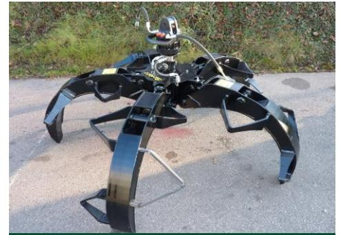
Robuste Ausführung mit 5 Zylindern
