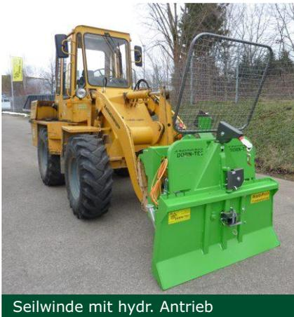
Seilwinde mit hydr. Antrieb
