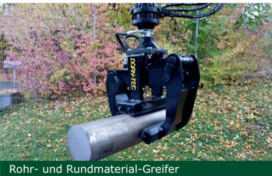
Rohr- und Rundmaterial-Greifer
