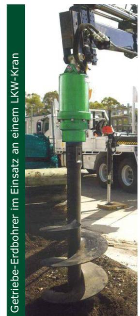
Getriebe-Erdbohrer im Einsatz an einem LKW-Kran
