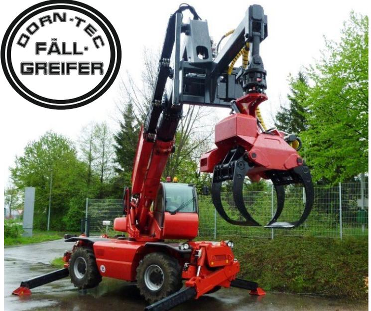
Fällgreifer im Einsatz an einem Teleskoplader
