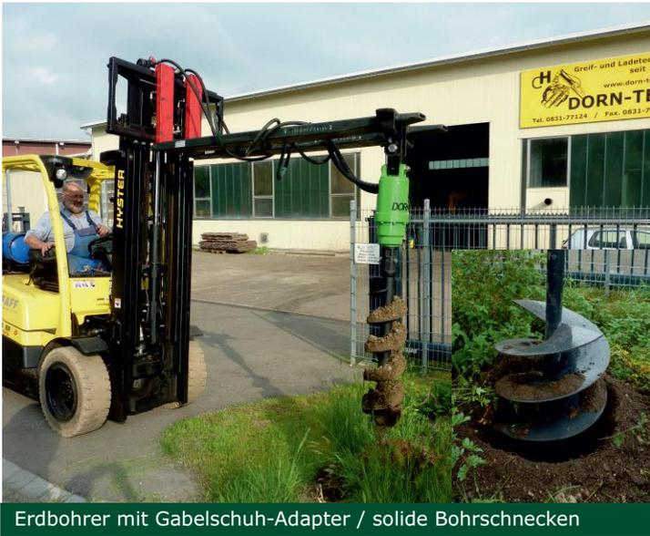
Erdbohrer mit Gabelschuh-Adapter / solide Bohrschnecken
