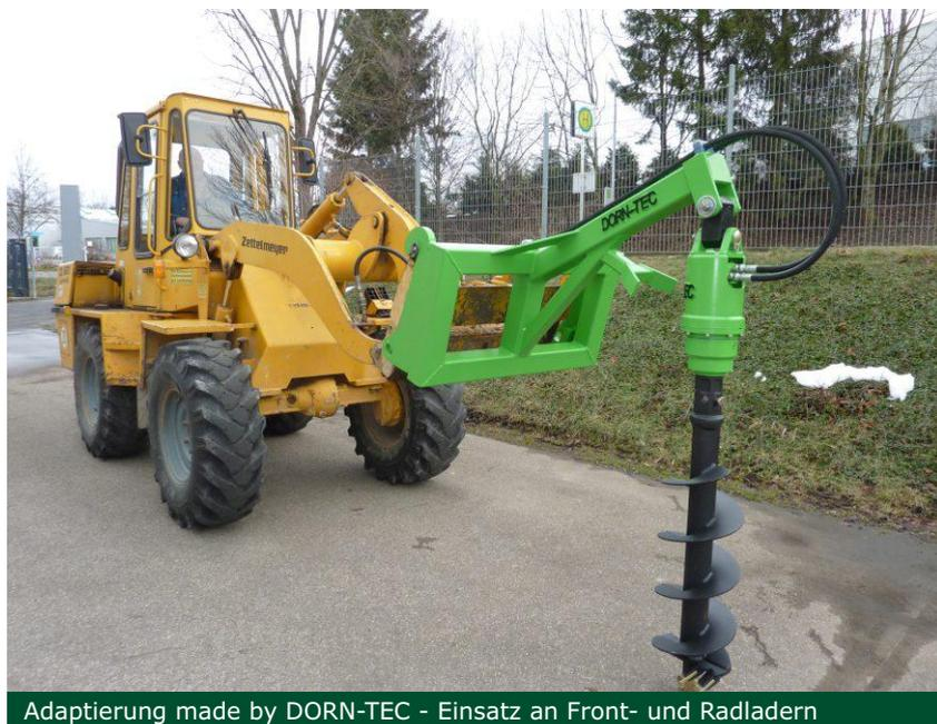
Adaptierung made by DORN-TEC - Einsatz an Front- und Radladern
