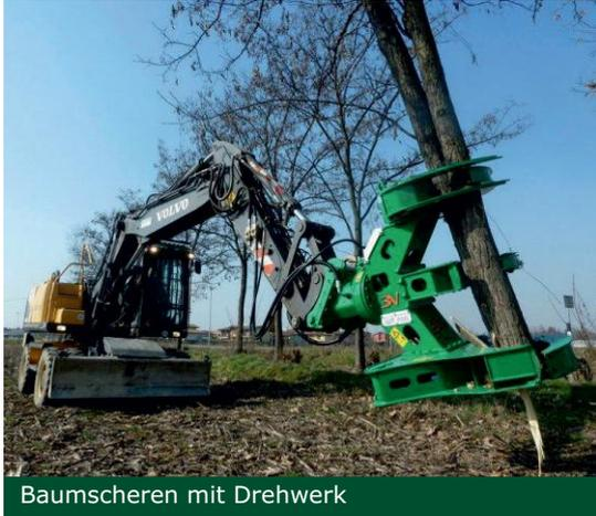
Baumscheren mit Drehwerk
